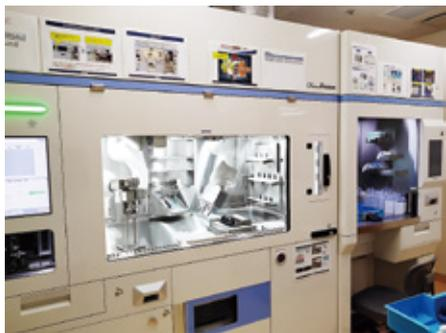
この装置は抗がん剤調製ロボットと呼ばれるもので、調剤ロボットの最先端機器です。国内でも導入している病院はまだ少数で、おそらく北陸3県では当院が初です。2本の人の腕のような機械（ロボットアーム）が、バイアルの抗がん剤を溶解し、必要量を正確に抜き取って点滴に注入することができます。薬剤師が行ってきた調製をロボットが代行するメリットはいろいろありますが、最大のメリットは、ロボットが稼働している時間を薬剤師は他の業務（調剤や服薬指導など）に使用することができる、ということです。
